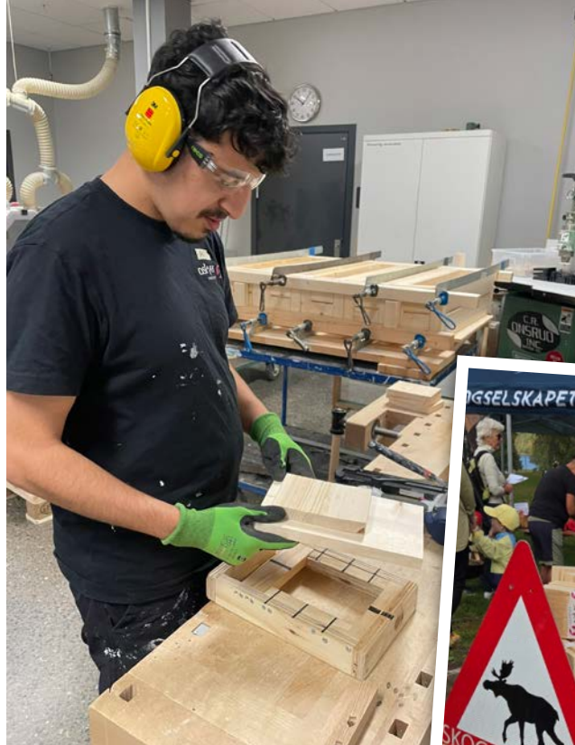
Ved hjelp av en praktisk mal stiftes takdelene til fuglekassene sammen. Taket trenger ikke skrues, og er dermed enkelt å fjerne når kassene skal rengjøres.
